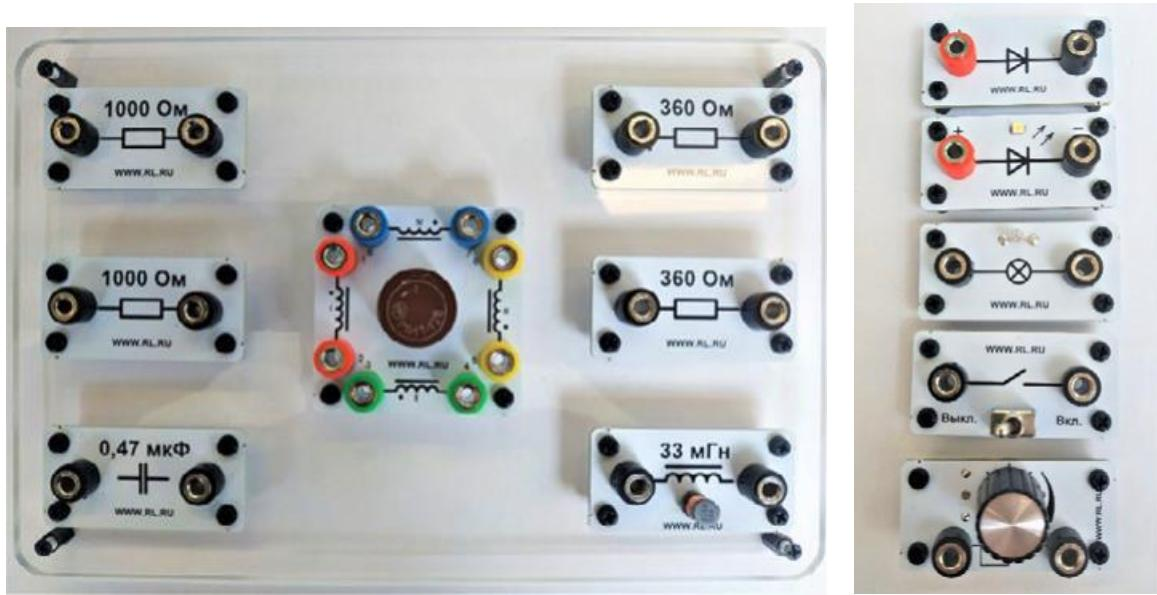
Для изучения законов постоянного и переменного тока в комплект включены дополнительно элементы электрических цепей: два резистора сопротивлением по 360 Ом, два резистора сопротивлением по 1000 Ом, лампочка, ключ, реостат, диод, светодиод, конденсатор ёмкостью 0,47 мкФ, катушка индуктивностью 33 мГн, набор катушек индуктивности.
