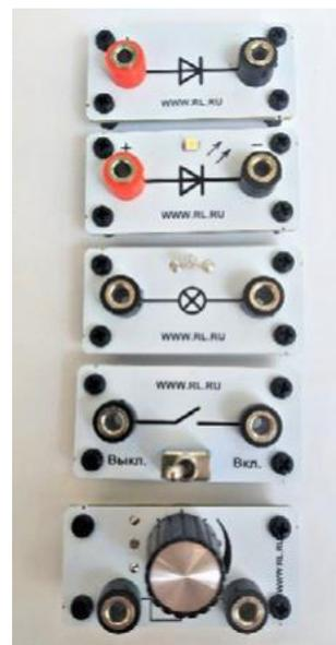
Для изучения законов постоянного и переменного тока в комплект включены дополнительно элементы электрических цепей: два резистора сопротивлением по 360 Ом, два резистора сопротивлением по 1000 Ом, лампочка, ключ, реостат, диод, светодиод, конденсатор ёмкостью 0,47 мкФ, катушка индуктивностью 33 мГн, набор катушек индуктивности.
